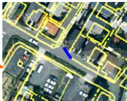
同じ位置を結ぶように線を入力します。線の方向が変換方向です。都市計画図に航空写真を合わせるので、航空写真から都市計画図の方向に線を入力します。
