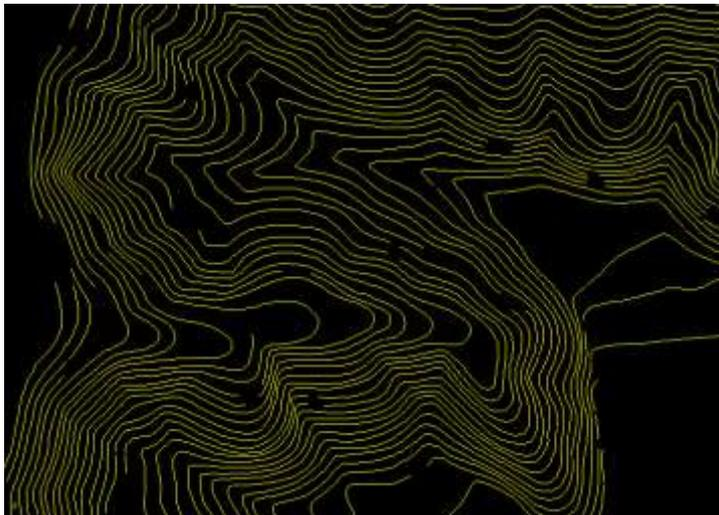
等高線だけを抽出したラスタデータに対してラスタ→ベクター括変換を実行します。点の間隔は任意に設定することができます。
