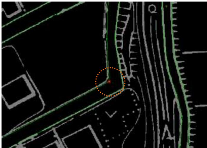
ラスタからずれているベクタラインにマークを表示します。ずれの許容値は任意に設定することができます。
